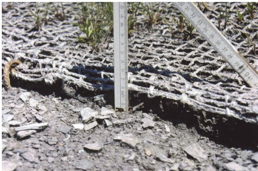
Figure 2. Couche de matériaux retenus sous un géofilet (Y. Crosaz)
